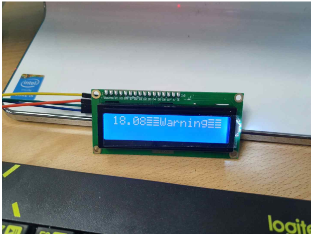
< 측정된 각도와 위험 정도를 알려주는 LCD >
